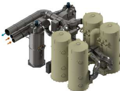
Natfilters + na-geschakelde Gaswassers 80.000 m 3 /u
